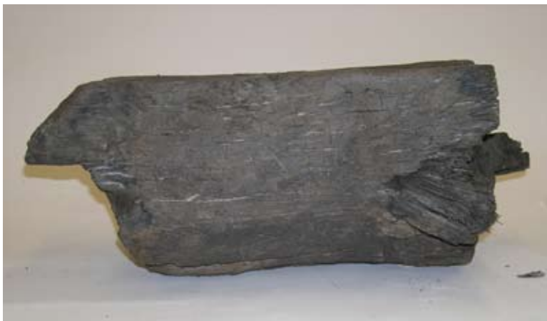
Eiken bouwfragment, hergebruikt als funderingspoer, spoor 3C (03WAA5, 57 x 20 x 24 cm)
